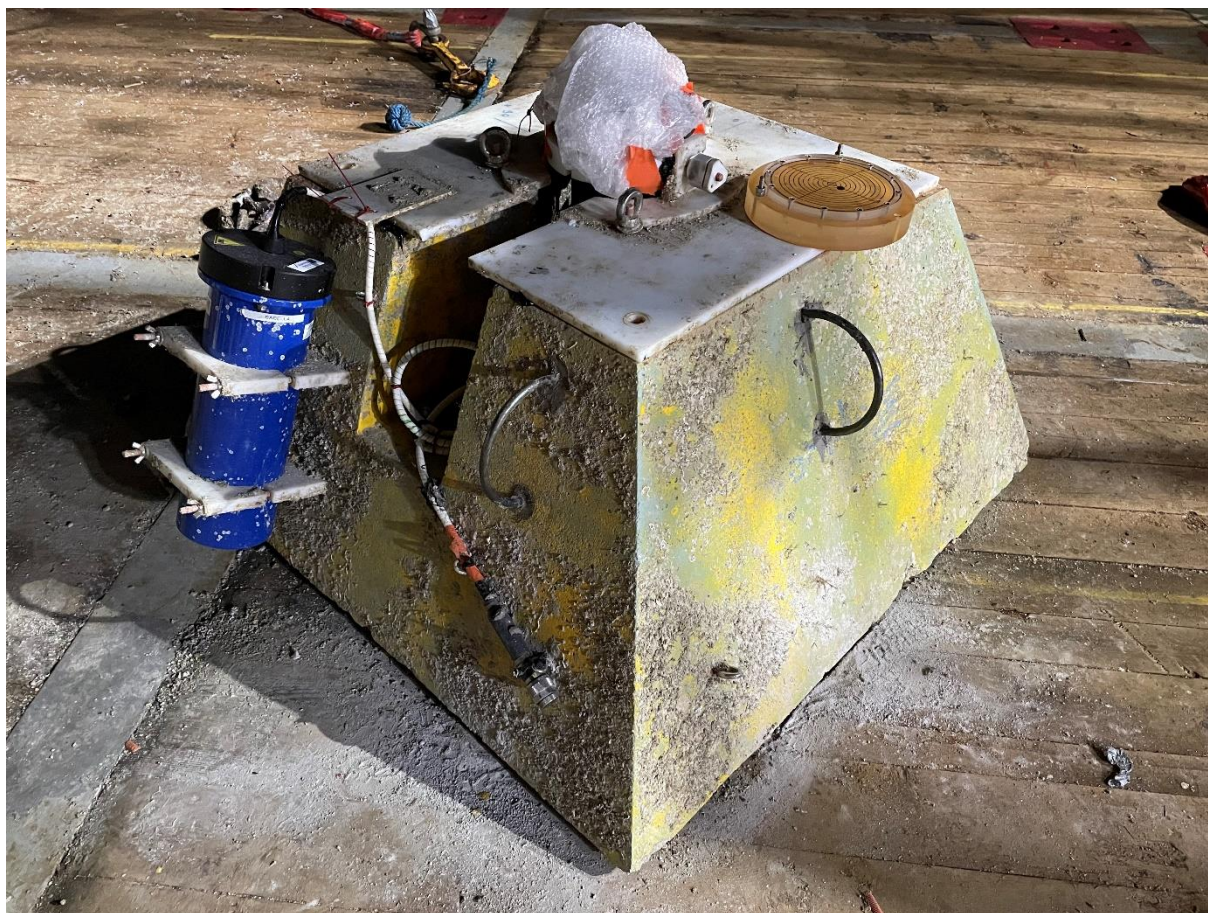
Figure 23 : station ADCP équipée d'un compas ROV
