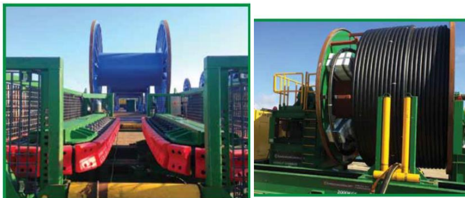
Figure 9 : photos de l'équipement pour dérouler le câble d'export
