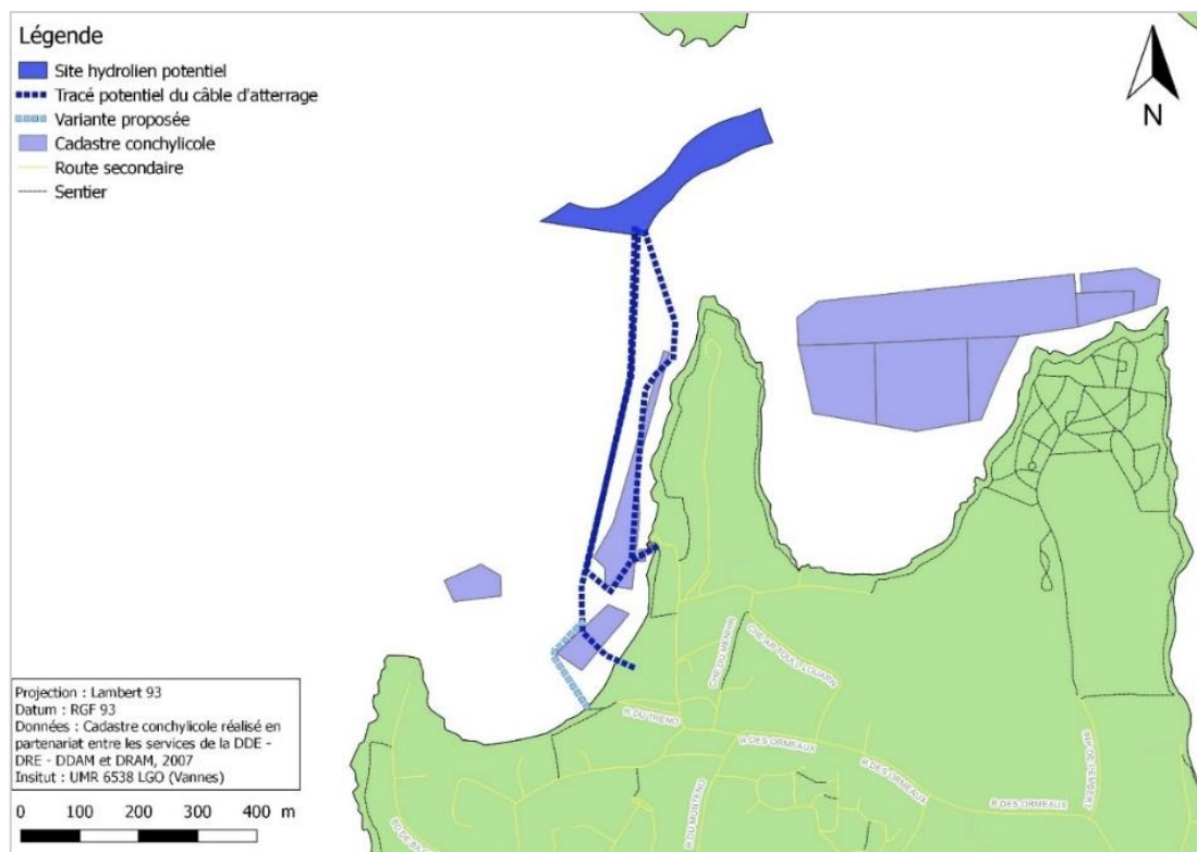
Figure 66 : Tracés du câble d'atterrage et proposition de variante (UBS, 2018)
