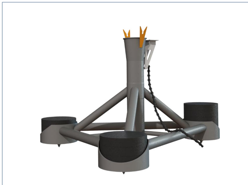
Figure 32 : Vue 3D de la conception préliminaire de l'embase D08 avec son système wet mate en attente (SABELLA)
