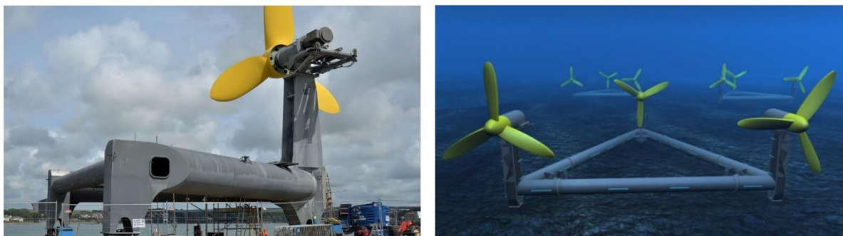
Figure 2 - Le TEL DeltaStream. À gauche : le dispositif construit et installé à Ramsey Sound. L'image date de 2014 à Pembroke Port. À droite : impression d'artiste d'un ensemble de dispositifs DeltaStream
